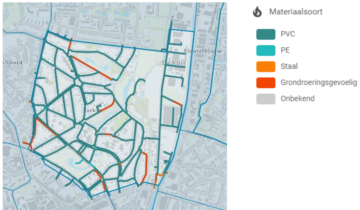
Afbeelding 3.2 Soort gasleiding aanwezig in De Parken. 9 % is hierbij grondroeringsgevoelig en zal vervangen moeten worden.
